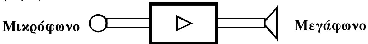
Το μικρόφωνο δίνει στην είσοδο του ενισχυτή ενεργό τάση  $10\text{mV}$ . Ο ενισχυτής έχει αντίσταση εισόδου  $1\text{K}\Omega$  και απολαβή τάσης  $500$ . Το μεγάφωνο έχει αντίσταση  $25\Omega$ . Να υπολογιστούν:
